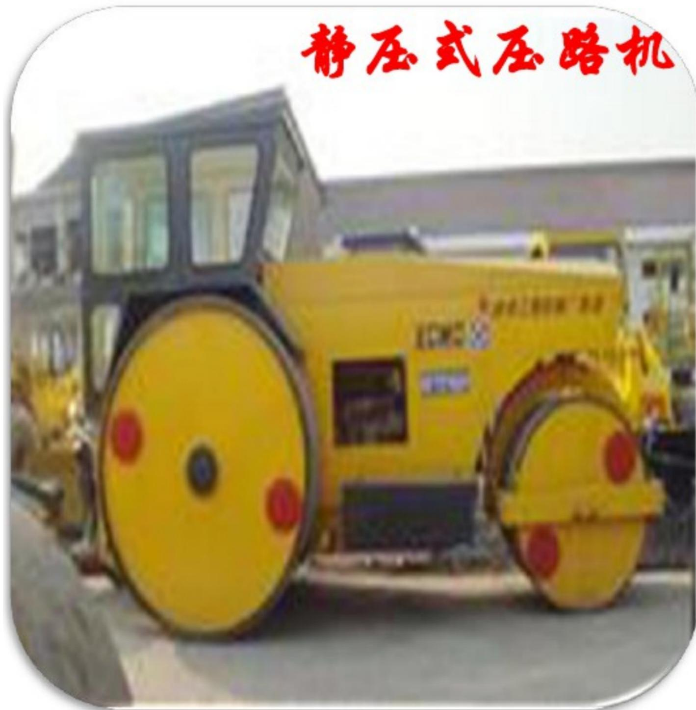
以机械本身的重力作用，适用于各种压实作业，使被碾压层产生永久变形而密实。又分钢轮式和轮胎式两类。
